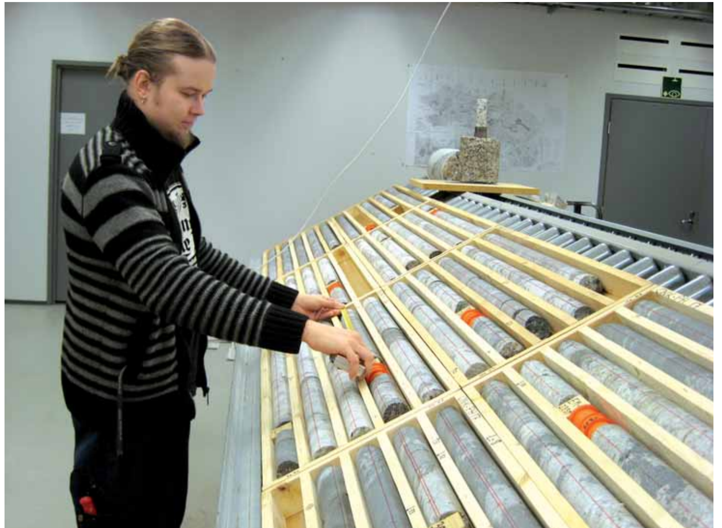
Posivan geologi Tuomas Pere tutkii pilottirei'istä saatuja näytteitä. Tutkimuksissa selviää muun muassa kivilaji, joka on tässä tapauksessa kiillegneissiä.
