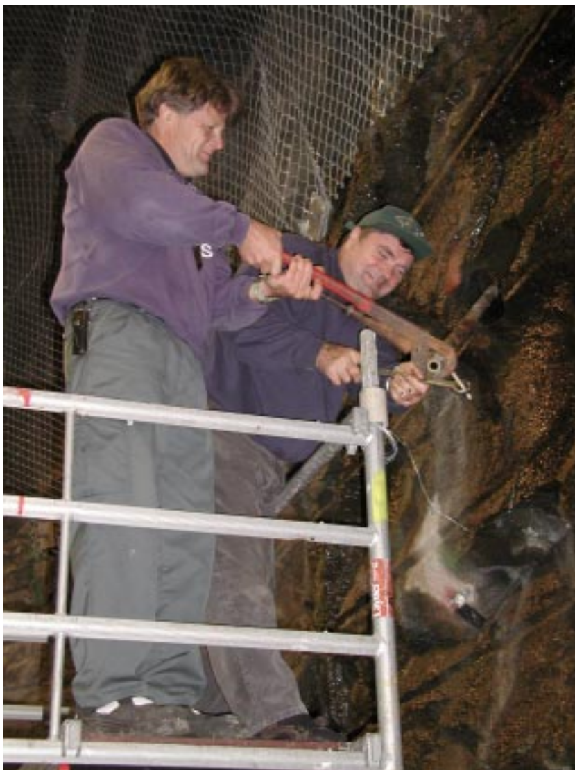
Sinkittyjen teräslevyjen näytteenotto käynnissä VLJ-luolassa elokuussa 2000.
