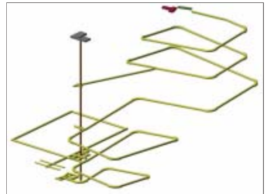
ONKALOn vertailun pohjana käytetyt luonnossuunnitelmat: vasemmalla kuiluvaihtoehto ja oikealla jatkokehittelyn pohjaksi valittu ajotunnelivaihtoehto.
