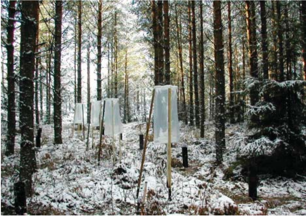
Metsän intensiivihavaintoalalle pystytettyjä lumenkeräimiä, joiden avulla tutkitaan mm. latvuston vaikutusta maahan satavan veden ja lumen kemialliseen koostumukseen.
