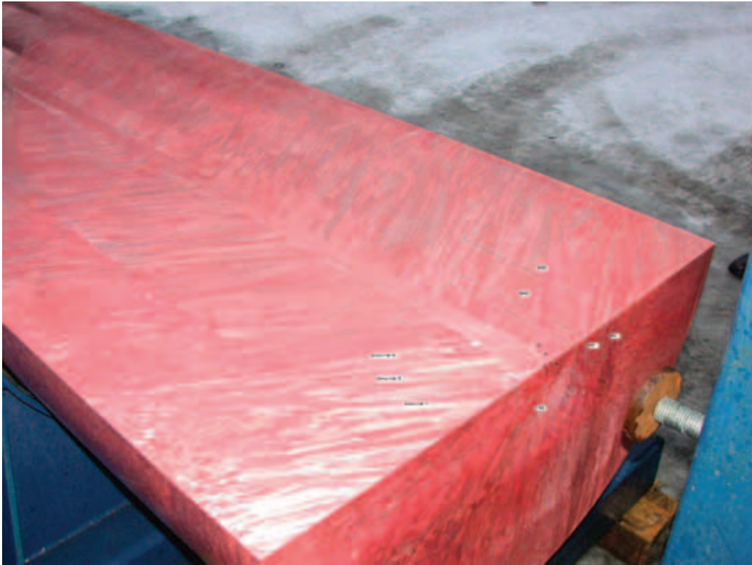
Kupariaihio koneistettuna aksiaalisesti keskustaan asti mahdollisten valuvikojen löytämiseksi.
