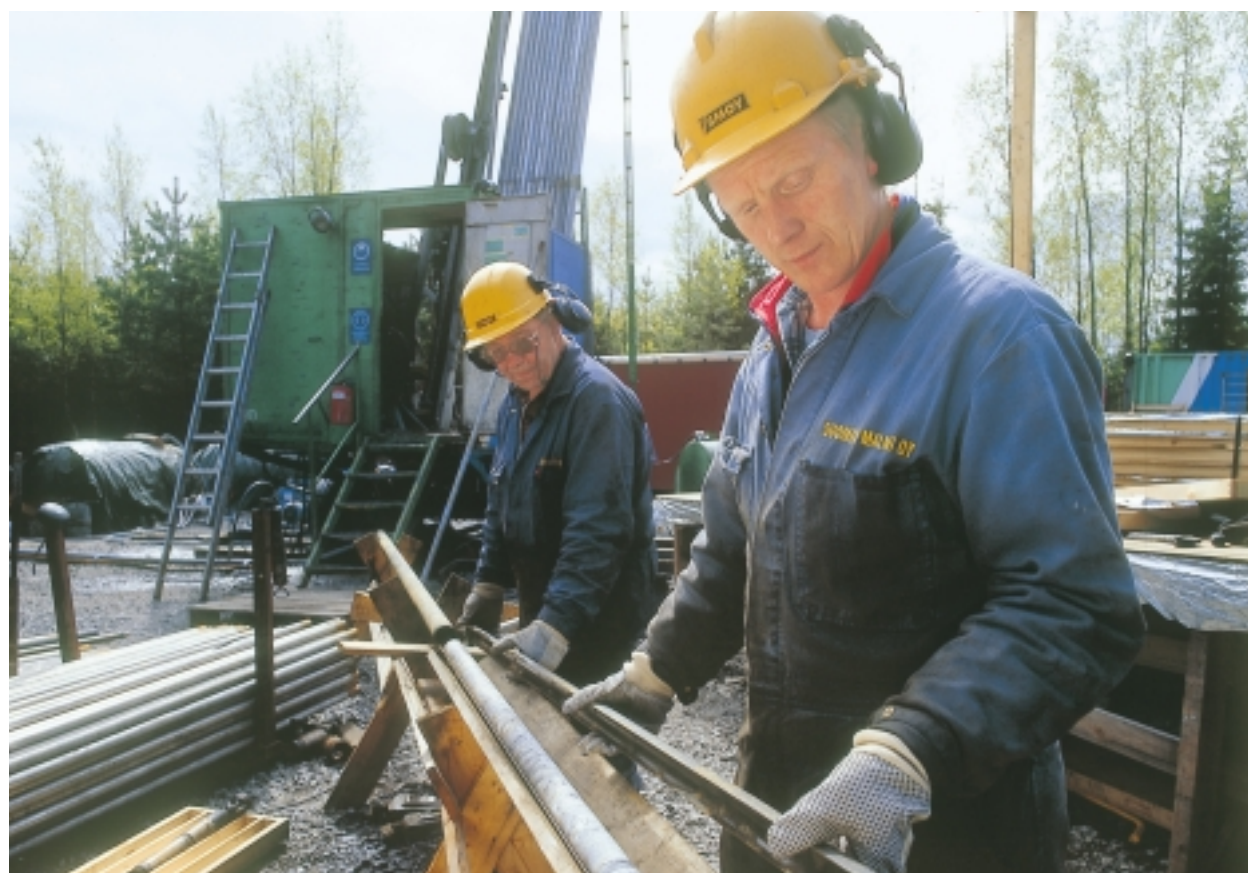
Olkiluodossa kairattiin kesän aikana neljästoista kairanreikä. Tulokset olivat tutkijoiden mieleen, sillä kr 14 tuotti hyvää ja ehjää kiviainesta.
