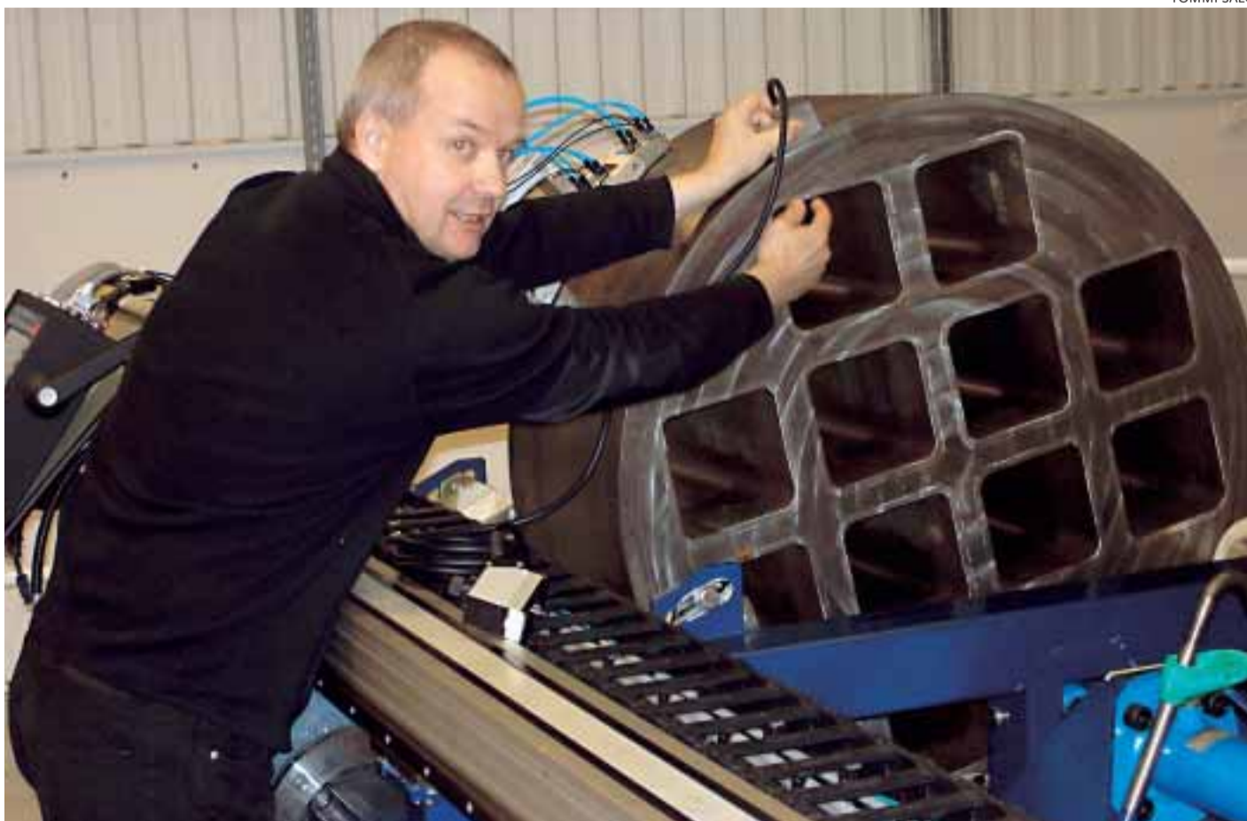
Posiva on tehnyt kapselointitekniikkaan liittyviä kokeita kapselilaboratoriossa Ruotsissa. Kehitysinsinööri Jorma Pitkänen on hyödyntänyt uutta ultraäänilaitteistoa loppusijoituskapselin sisäosan tarkastustyössä.
