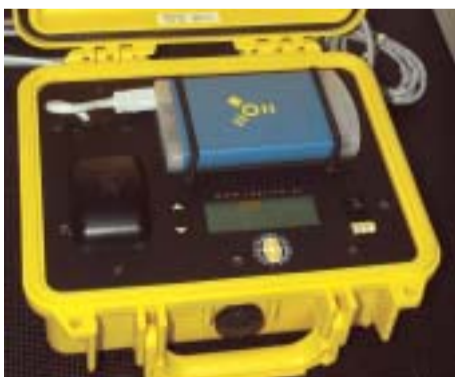
Tiedonkeruuyksikön avulla kerätään ja tallennetaan yhdeltä seismiseltä asemalta saatavat tiedot.
