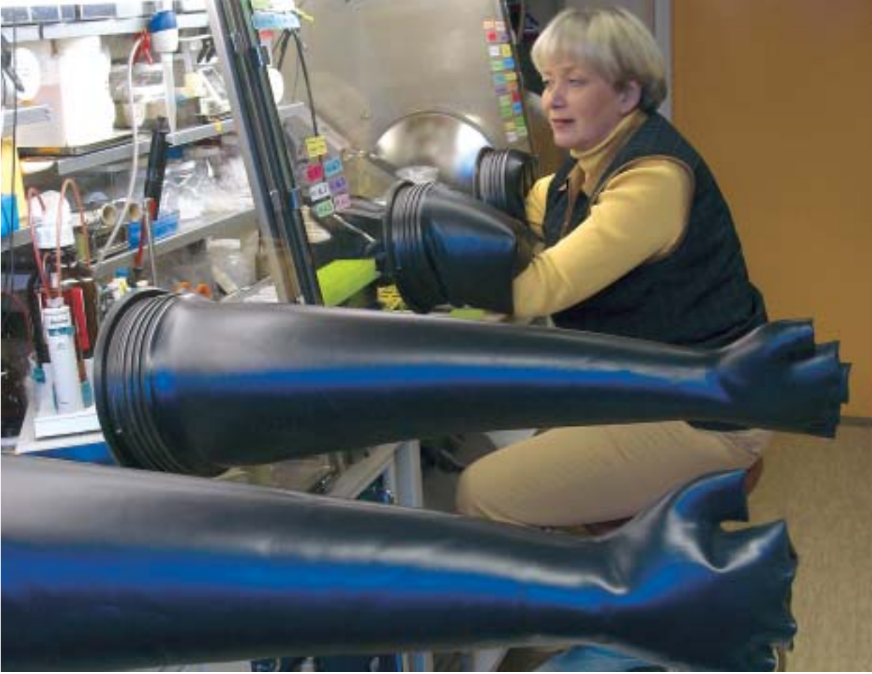
Sementin käyttäytymistä tutkitaan olosuhdekaapissa, jossa kallioperän olosuhteita simuloidaan ylläpitämällä hapettomia ja hiilidioksidittomia olosuhteita. Kokeiden perusteella kehitetään laskentamalleja, joiden avulla voidaan arvioida sementin pH:n käyttäytymistä pitkällä aikavälillä. Mittauksista vastaa erikoistutkija Ulla Vuorinen VTT Prosesseista.
