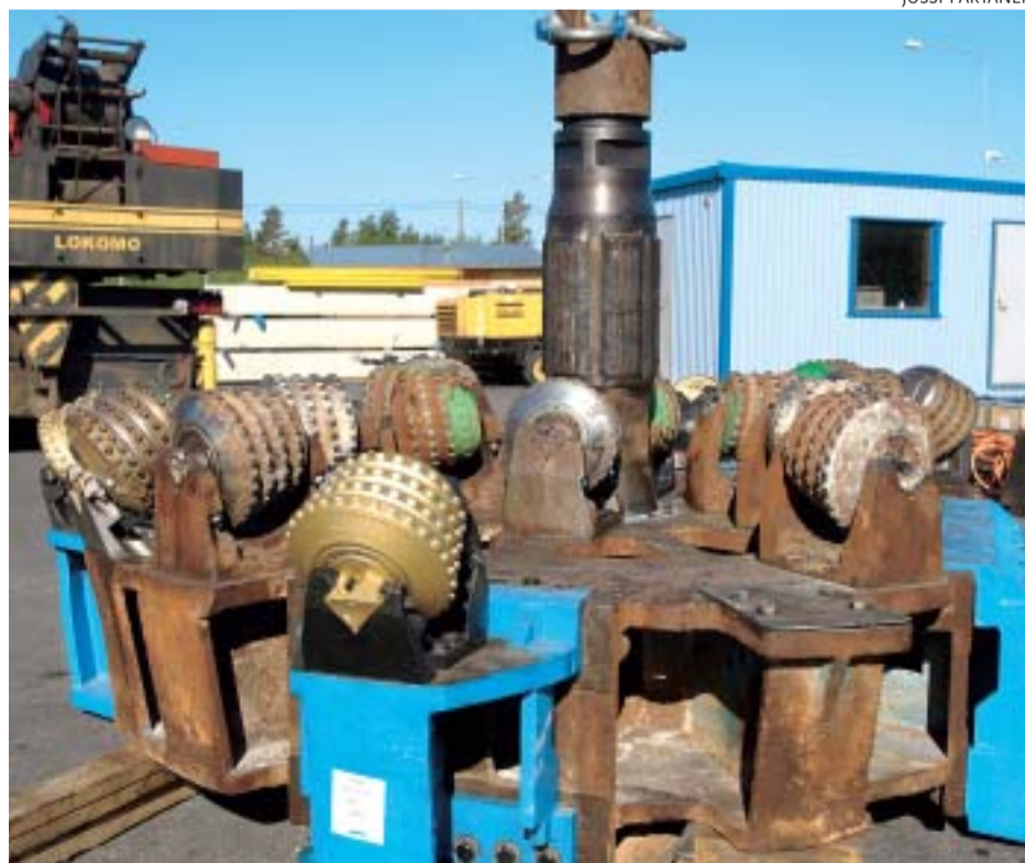
Posiva käyttää Olkiluodossa ruotsalaista urakoitsijaa nousunporauksessa. Avarrusterän halkaisija on 3,5 metriä. Kesäkuun alussa ONKALOon porattu poistoilmakuilu toimii raitisilmakanavana.
