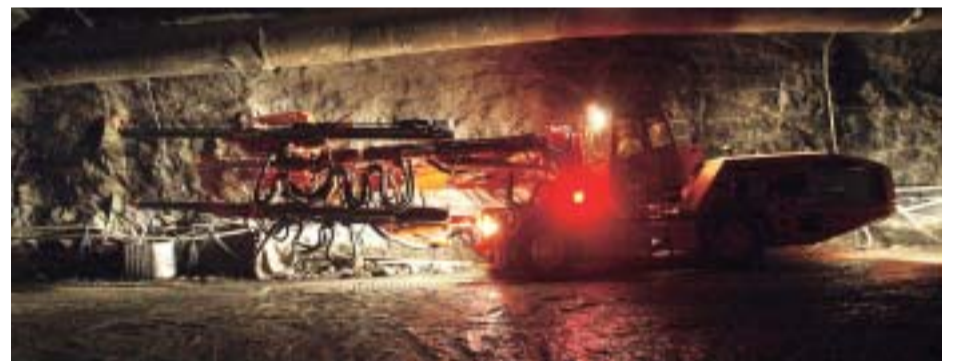
Olkiluodossa käytettävällä porausjumbolla on pituutta noin 17 metriä ja painoa 49 000 kiloa.
