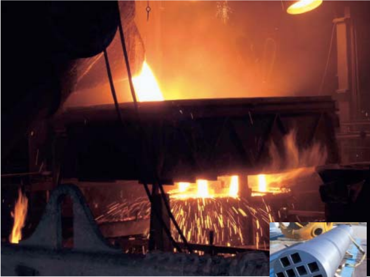
Kuparikapselin sisäosan valussa käsitellään 1 400-asteista sulaa rautaa. Valu on ohi parissa minuutissa. Ennen kuin kuparikapselin sisäosa on valmis tutkimuksiin, sitä on jäädytetty viikko ja se on puhdistettu ja sahattu oikeisiin mittoihin.
