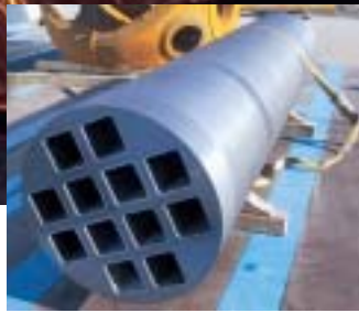
Kuparikapselin sisäosan valussa käsitellään 1 400-asteista sulaa rautaa. Valu on ohi parissa minuutissa. Ennen kuin kuparikapselin sisäosa on valmis tutkimuksiin, sitä on jäädytetty viikko ja se on puhdistettu ja sahattu oikeisiin mittoihin.
