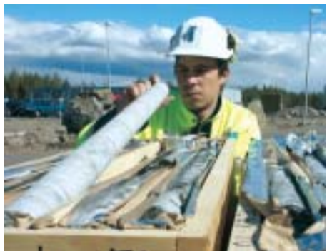
Jussi Mattilan mukaan kairattu kivi on ollut laadultaan hyvää. Niissä on havaittavissa vain vähän rakoilua ja rikkonaisia kohtia.
