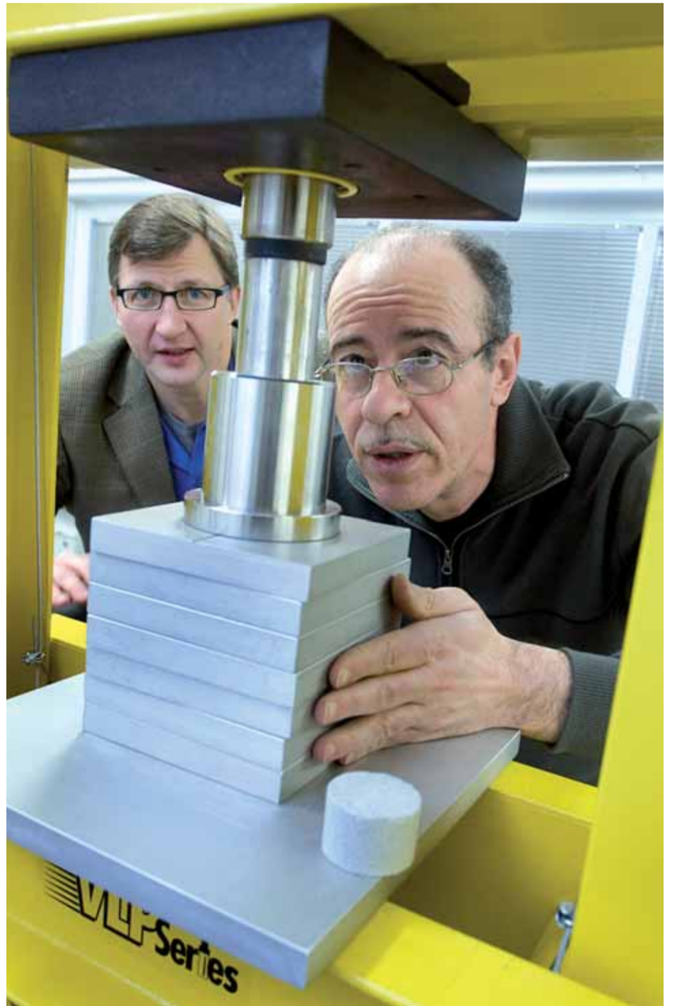
Bentoniittisavijauheesta voidaan puristaa savikiekoja. B+Techin toimitusjohtaja Jorma Autio (vas.) ja Karim Hanana näyttävät, kuinka bentoniittijauheen puristuslaite toimii.
