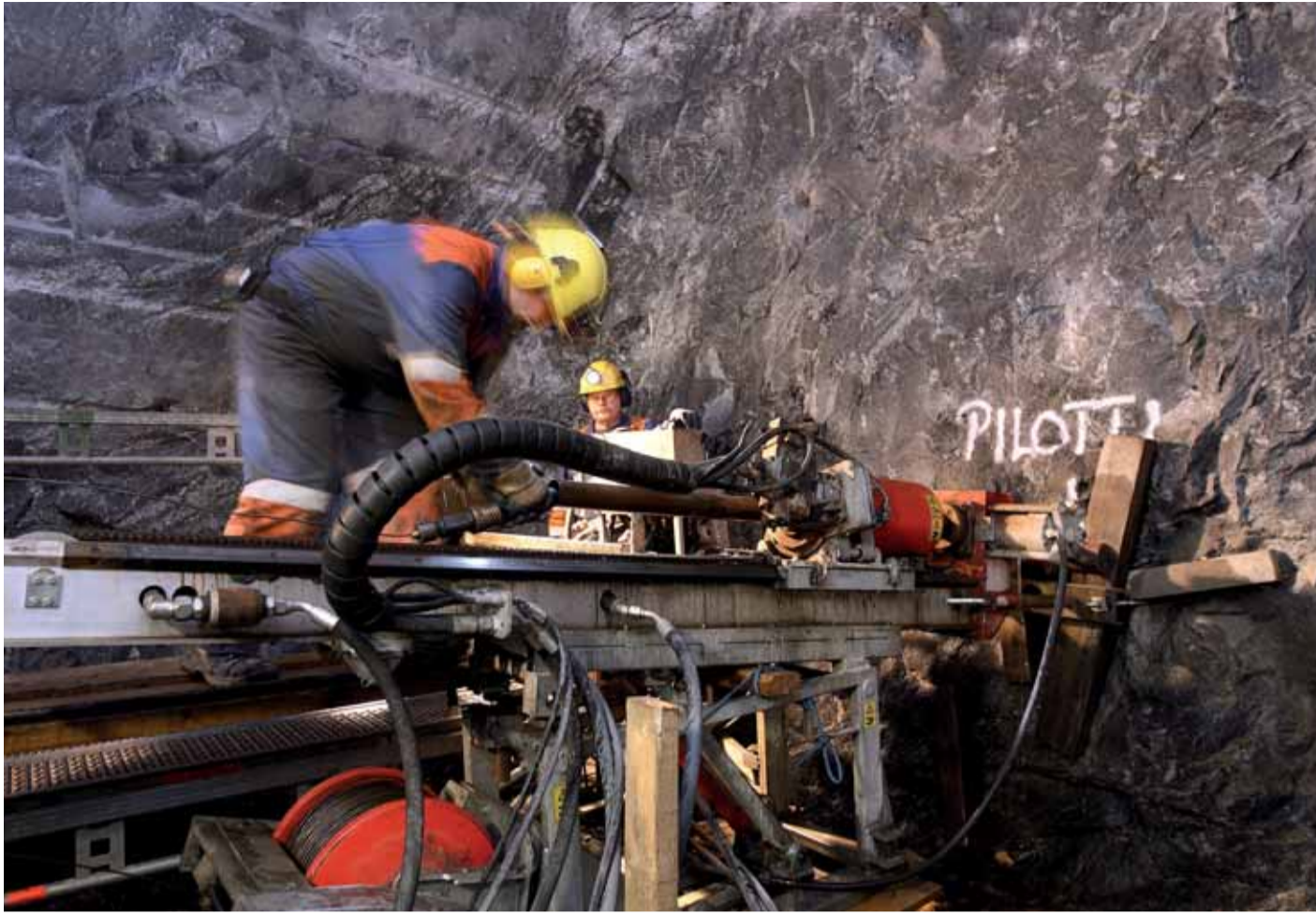
Reijo Nisula ja Ari Nikkanen valmistautuvat kairausnäytteen ottoon ONKALON pilottireiästä.
